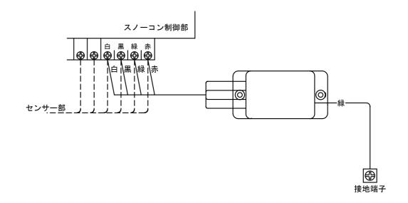
※御注意 (1) センサー部への接続端子は絶対にメガー等の高電圧はかけないで下さい。
