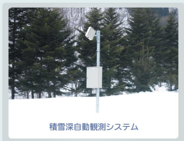
雪情報通信システム（積雪深+積雪重量）
