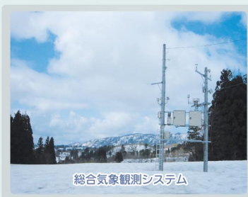
雪情報通信システム（積雪深+積雪重量）
