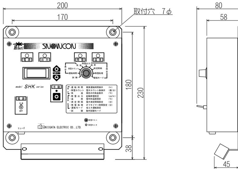
※ 旧型スノーコンと取り替える場合は、専用取付金具 HK-1 を使用することで取付け穴を開けることなく取付けることができます。
