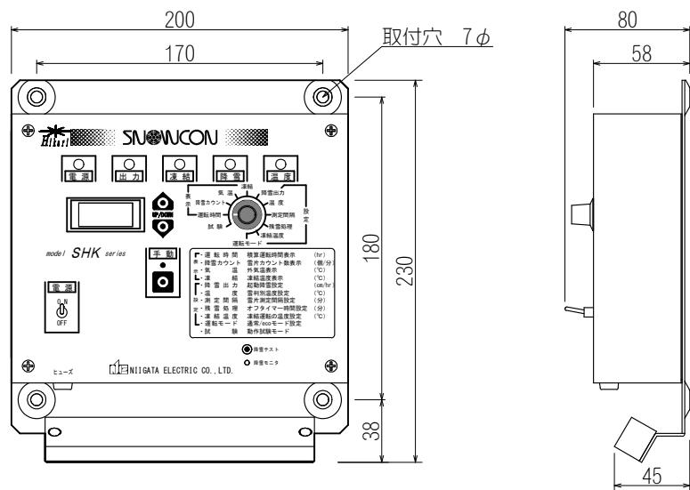
※ 旧型スノーコンと取り替える場合は、専用取付金具 HK-1 を使用することで取付け穴を開けることなく取付ることができます。
