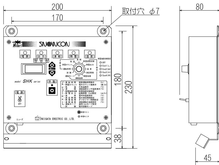
※ 旧型スノーコンと取り替える場合は、専用取付金具 HK-1 を使用することで取付け穴を開けることなく取付けることができます。
